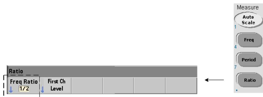
频率比测量是对两个信号的测量，其中一个信号通常用作参考信号（图 3-2）。信号可以是不同的波形，并且可应用至计数器中的任一两个通道的组合。
